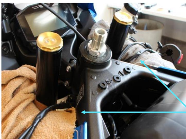
Mutter und Klemmschrauben von der Gabelbrücke lösen.
