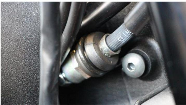
Die längere Stahlflex-Bremsleitung, nach Montagehinweisen des Fahrzeugherstellers, montieren.
