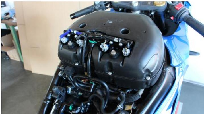
Sitzbank, beide Tankverkleidungen und den Tank entfernen.
