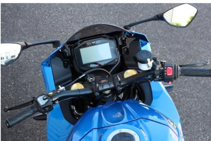
Zur endgültigen Montage der Bedienelemente ist es notwendig, die Löcher für die Zentrierstifte zu bohren. Dazu die Bedienelemente ausrichten und die Stellen für die Zentrierstifte markieren (mit Fett auf den Stiften andrücken). Anschließend die markierte Stelle ankörnen und mit einer Bohrung (Durchmesser und Tiefe entsprechen dem Zentrierstift) versehen.
