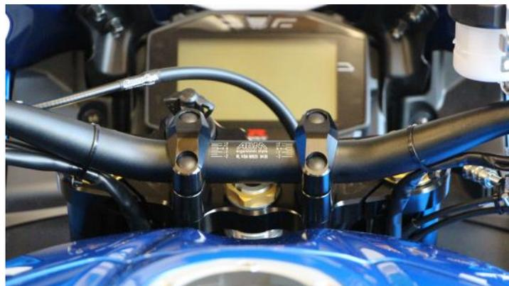
Bedienelemente und Griffarmaturen auf den Lenker schieben und alles provisorisch vormontieren.
