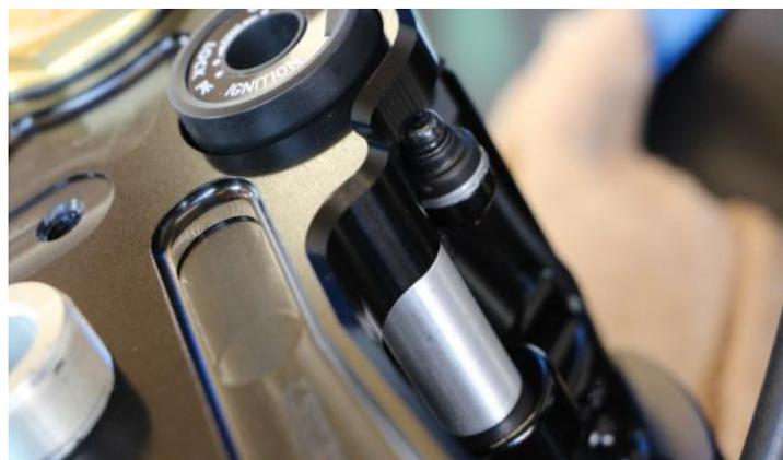
Zündschloss durch Lösen der Befestigungsschrauben mit Spezialwerkzeug oder durch Ausbohren entfernen.
