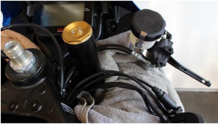
Bremsflüssigkeit in der Bremsanlage absaugen.
