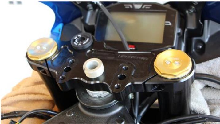
Gabelbrücke mit der originalen Mutter und U-Scheibe (Drehmoment nach Herstellerangaben, s. Werkstatthandbuch) sowie 2x M8x20 (Anzugsdrehmoment 18-21 Nm) Klemmschrauben befestigen.
