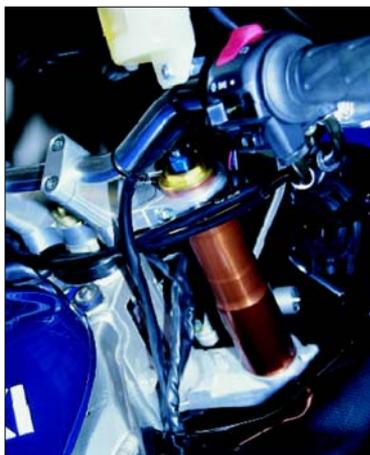
**Hinweis:** Mit montiertem Superbike-Umbau lässt sich der Tank nicht mehr nach hinten wegklappen und muss für erforderliche Servicearbeiten auch an der hinteren Befestigung demontiert werden.
