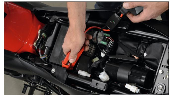
5. Die schwarze Klemme an Fahrzeugmasse (an einem unlackierten, blanken Teil) anschließen (Schraubenkopf, Scharnier, Motorkühlrippen etc.).
