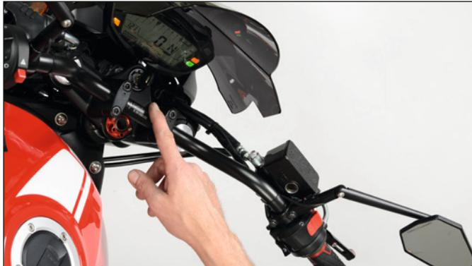
**8. Starter des Fahrzeugs betätigen, sodass der Motor an- springt.**
