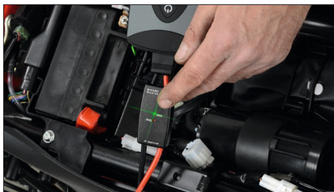
4. Die rote Klemme des Starthilfekabels am Pluspol der Batterie anschließen und auf guten Kontakt achten. Korrodierte Pole sachte sauber schaben. Der ProCharger Starthilfebooster darf an allen Typen von Fahrzeugbatterien angeschlossen werden, inkl. Lithium-Ionen-Batterien.
