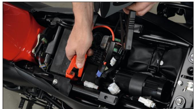
**12. Anschließend mind. 30 Minuten das Fahrzeug fahren, um die Batterie über die Lichtmaschine aufzuladen. Den Motor währenddessen nicht ausgehen lassen.**
