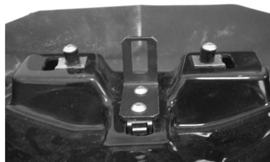
Bevor Sie alle Schrauben festziehen, setzen Sie die Abdeckung auf das Heck und richten Sie die Klemme und den Haltewinkel entsprechend aus. Erst wenn der Befestigungssatz auf die Original-Aufnahme passend sitzen, alle Schrauben fest anziehen.
