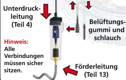
Stellen Sie sicher, dass alle Verbindungen fest sitzen und nicht andere Motorradkomponenten wie z.B. Gaszüge behindern. Leitungen dürfen nicht mit Motoren- und Auspuffkomponenten in Berührung kommen die im Betrieb heiß werden.
