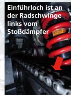
Einführloch ist an der Radschwinge links vom Stoßdämpfer
