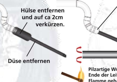
Drücken Sie die übriggebliebene Unterdruckleitung in die Förderleitung um die Installation durch die Radschwinge zu erleichtern.
