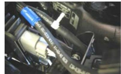
Setzen Sie das 6mm T-Stück ein und verbinden Sie es mit dem schwarzen Unterdruckfilter.
