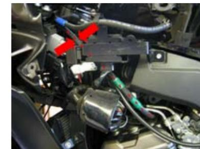
Zerschneiden Sie den Gummitteil des Unterdruckschlauches mit dem grünen Klebeband.
