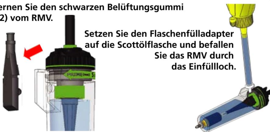
Setzen Sie den Flaschenfülladapter auf die Scottölflasche und befallen Sie das RMV durch das Einfüllloch.
