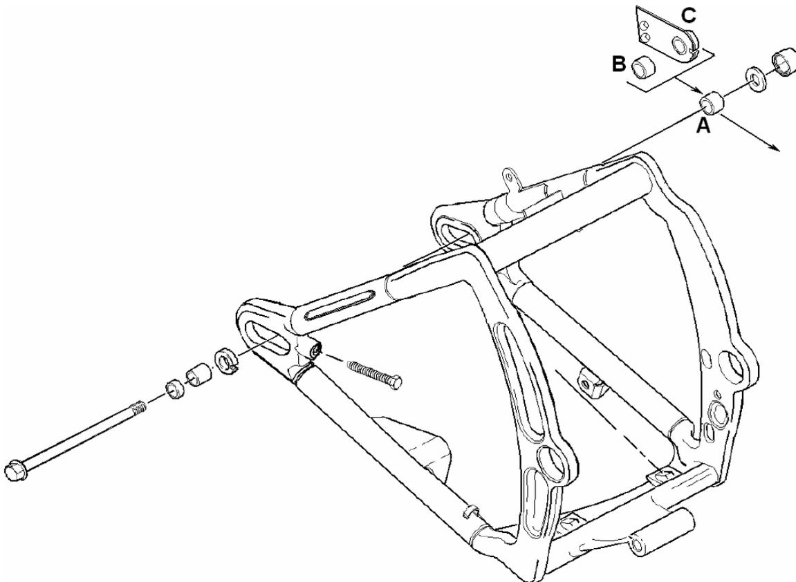
Ersetzen Sie die Hülse (A) durch den Kennzeichenträger (C) und die Distanzhülse (B).
