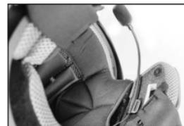
Dans le cas du microphone filaire, fixez la bande velcro (inclue pour le micro câblé) à l'intérieur de la mentonnière pour casques intégraux. Placez le microphone filaire sur la bande velcro et fixez le connecteur du microphone au connecteur à 2 broches du câble de l'unité principale.
