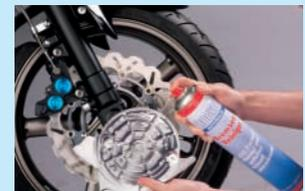
**3.** **Bremsträgerplatte und Bremstrommel ausgiebig reinigen.**
