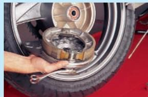
**1.** **Hinterrad ausbauen und Bremsträgerplatte abnehmen.**
