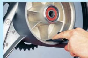
**6.** **Bremstrommel untersuchen und ggf. mit Schmirgelpapier abziehen.**
