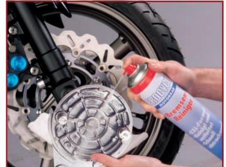
**3.** Bremsträgerplatte mit Bremsreiniger säubern
