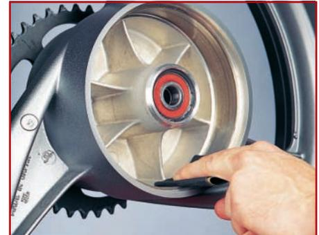
**6.** **Bremstrommel prüfen, ggf. mit Schleifpapier glätten**
