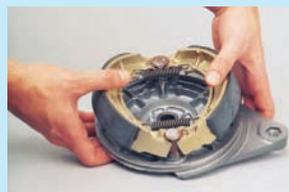
**5.** **Kupferpaste an die Auflagepunkte der Bremsbeläge und Bremsbeläge montieren.**
