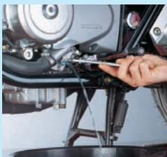
**1. Ablassschraube und Einfülldeckel öffnen.**
