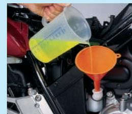
**4. Ausgleichsbehälter befüllen. Nach Abkühlung nochmals kontrollieren.**
