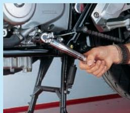
**2. Ablassschraube mit neuer Dichtung versehen und mit dem Drehmomentschlüssel festziehen.**
