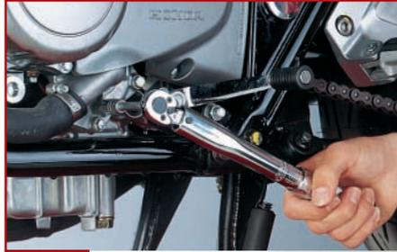
**2.** Schraube mit Drehmoment-schlüssel festziehen
