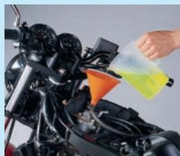
**3. Kühlmittel einfüllen und Motor starten. Temperatur und Kühlmittel-Level im Auge behalten.**
